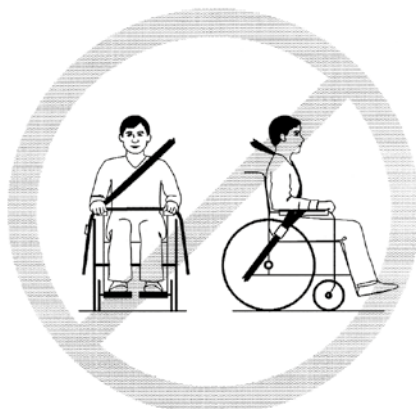
Obrázek 4: Pás by měl být opřený přímo o tělo, nikoliv o součásti vozíku jako opěrky nebo kola.
