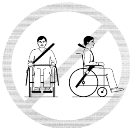
Abbildung 4: Die Rückhaltgurte müssen eng am Körper der beförderten Person anliegen und dürfen deswegen nicht von Rollstuhlbauteilen (wie beispielsweise Armlehnen) vom Körper weggehalten werden. Es reicht NICHT aus, nur den Hüftgurt anzulegen
