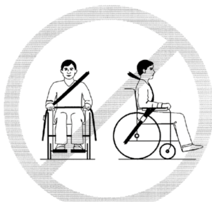
Figura 4: El cuerpo no debe estar presionado ni sujeto por componentes de la silla de ruedas como son los reposabrazos o las ruedas.
