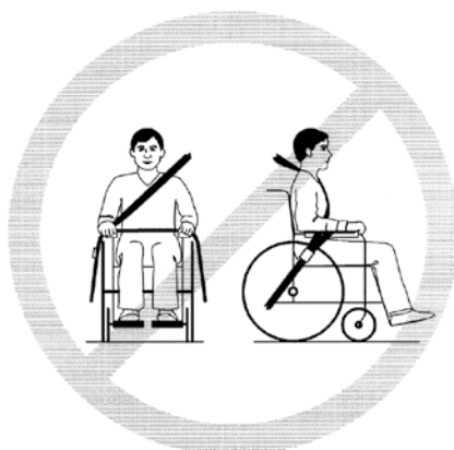
Figure 4: Les dispositifs de retenue ne doivent pas être écartés du corps par des composants du fauteuil tels que les accoudoirs ou les roues.
