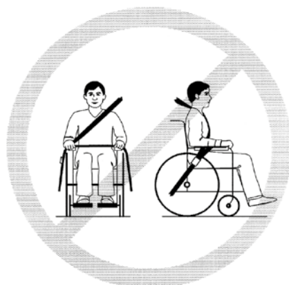
図4: アームレストや車輪などの車椅子部品によって、シートベルトが体から離れないようにしてください。
