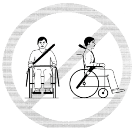
见图4。：此种固定带不能绕过轮椅部件如扶手或轮子而远离患者身体。
