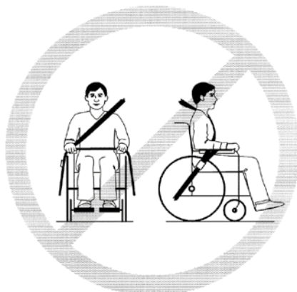
Afbeelding 4: De veiligheidsgordel moet zo nauwsluitend mogelijk over het lichaam zitten en mag niet worden tegengehouden door rolstoelonderdelen, zoals zijsteunen of achterwielen.
